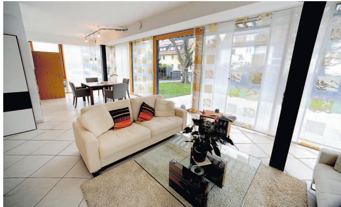
Das Wohnzimmer wird zum Wintergarten: Rechts im Bild der Stahlträger, der das Obergeschoss stützt.
